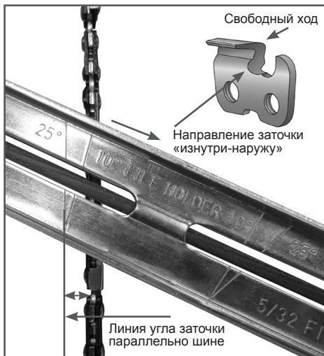
Рис. 22 Расположение линии угла заточки
